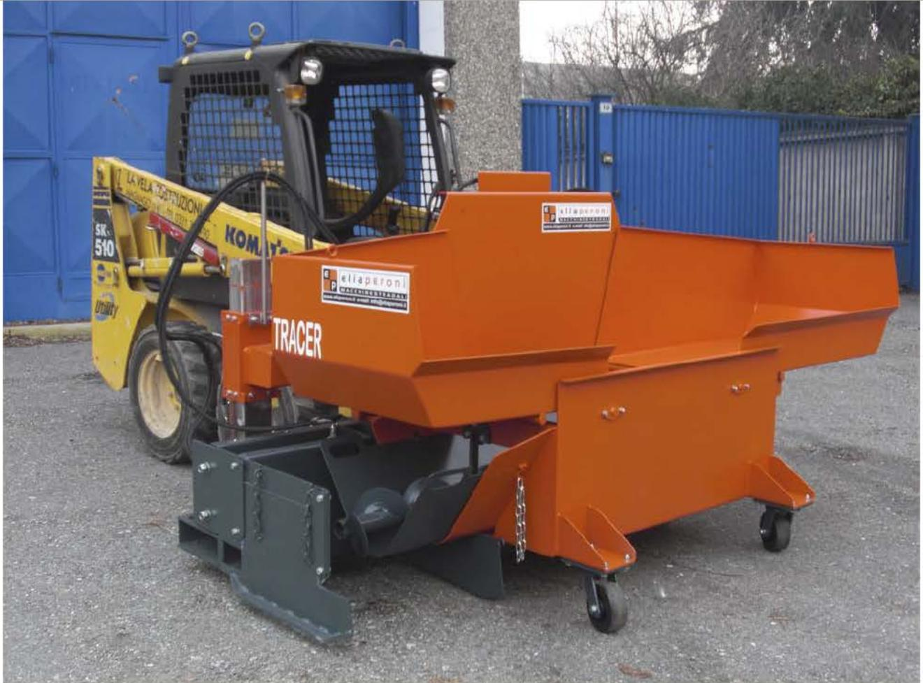
La **micro TRACER** es una innovadora extendedora de asfalto para mini cargadoras y retro excavadoras , la solución ideal para pequeñas y grandes empresas de mantenimiento de carreteras.
